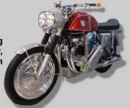
MÜNCH MAMMUT: Motorrad mit NSU-Automobilmotor
