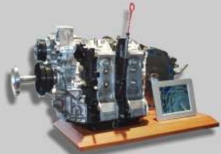
MAZDA RENESIS: Kreiskolben-Demo-Modell
